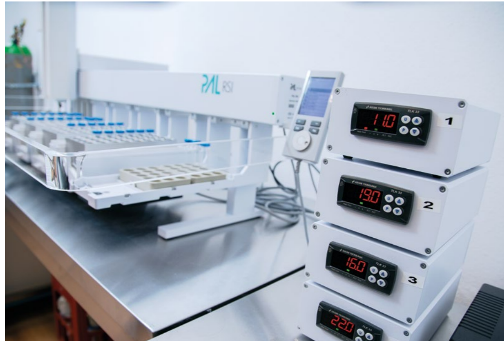
Het op de juiste temperatuur brengen van de monsters is met deze autosampler van PAL geautomatiseerd. De opstelling is gekoppeld aan de PTR-MS van Ionicon voor bepaling van de massagetallen van de geurstoffen.
